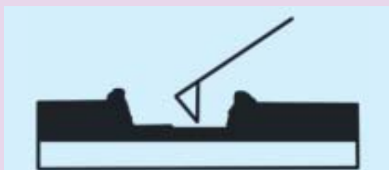
شکل ۲. طرح شماتیک ایجاد تغییرات روی سطح با روش مکانیکی
