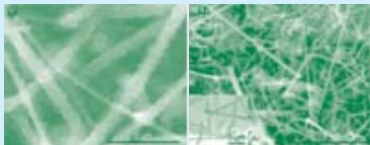
تصویر میکروسکوپ الکترونی پیمایشگر از نانوسیم‌های سیلیکونی قبل از (الف) و بعد از (ب) چرخه الکتروشیمیایی.
