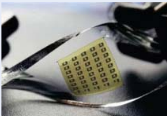
مدار مجتمع ساخته شده از نانوروبان‌های سیلیکونی با قابلیت کشش پذیری مکانیکی که در داخل یک لاستیک شفاف قرار داده شده است.
